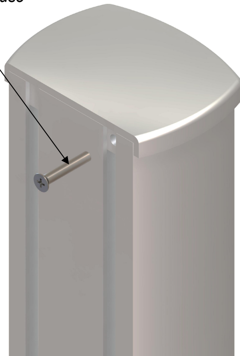
Mettre en place le bouchon puis le verrouiller à l'aide d'une vis autoforeuse 4,8x32
